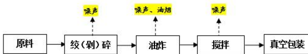
图 3-4 调味品生产工艺流程图
