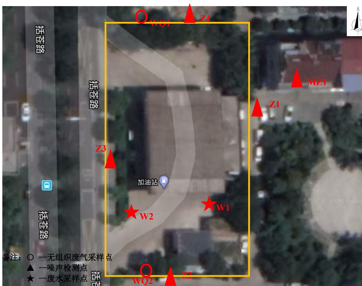
图 4-6 废水、废气、噪声监测点位示意图
