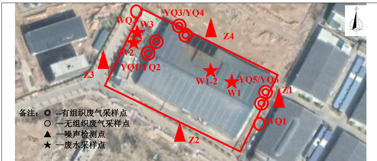
图 3-6 废水、废气、噪声监测点位示意图
