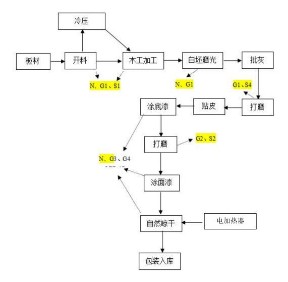
图 3-5 项目生产工艺流程图及产污节点图
