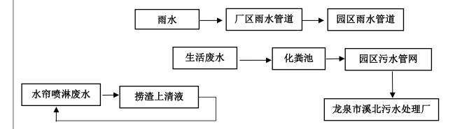
图 4-1 项目废水治理流程图
