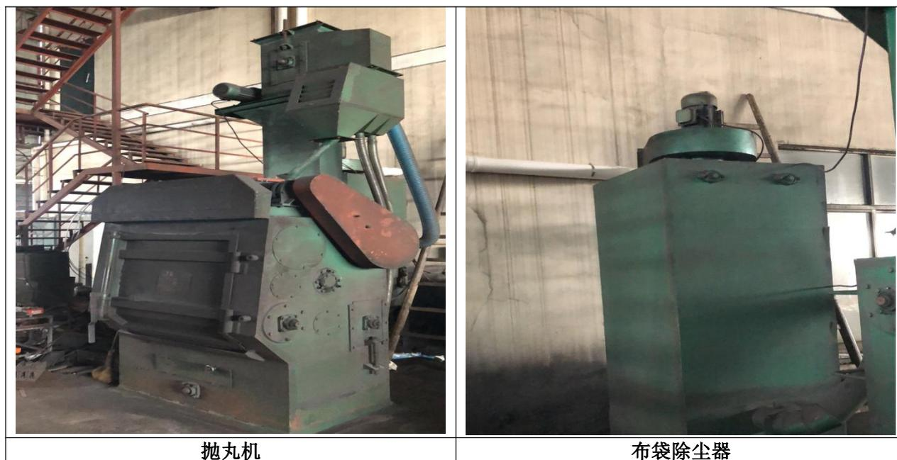
图 4-2 项目抛丸粉尘治理流程图
