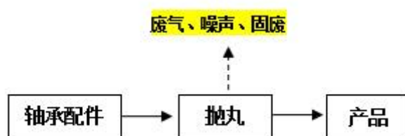
图 2-4 抛丸线工艺及产污环节流程图
